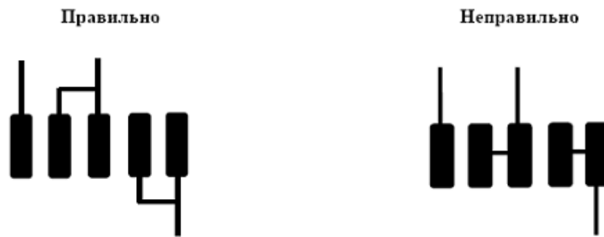
Рис. 4. Примеры подвода проводников к площадкам микросхем
