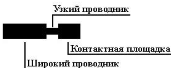
Рис. 3. Примеры подвода широких проводников к контактным площадкам
