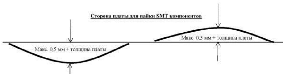
Рис. 2. Допустимая деформация заготовки платы
